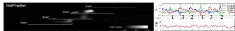
回転非同期軸振動を引き起こす超同期旋回キャビテーションの様子
