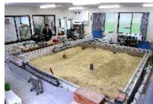
地雷、遺跡を計測するGPRの開発
