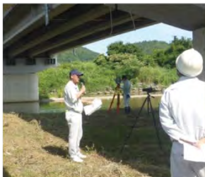
レーザースキャナでの計測の様子
