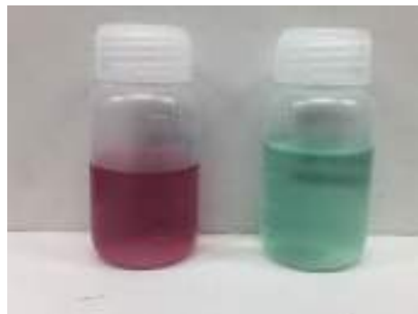
Fig. クエン酸(H 3 Cit)を用いたLiCoO 2 の酸浸出
